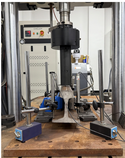
Fig 6 정적, 동적수직강성 시험
