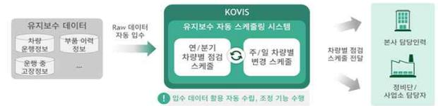
**Fig 6.** 유지보수 자동 스케줄링 시스템 프로세스
