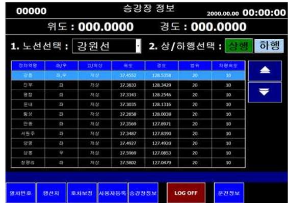
Fig. 3 화면 장치(DU2) 인터페이스 구성
