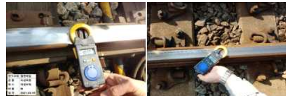
Fig 5. 레일 자기장 측정 사례
