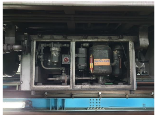
Fig 1. 철도차량에 설치된 스크루 공기압축기
