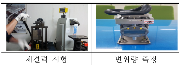
Fig. 2 체결력 시험 및 변위량 측정
