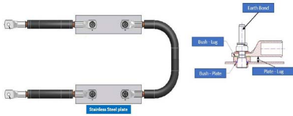
Fig. 3 접지저항성능 시험 시편
