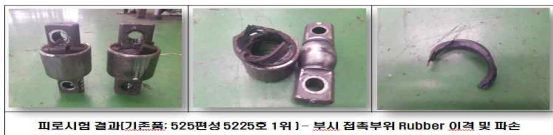
Fig. 5 피로시험 후 파손된 고무부시
