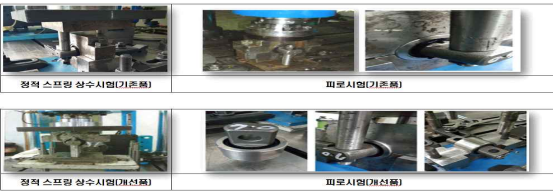
Fig. 4 기준품 및 개선품 성능시험 과정
