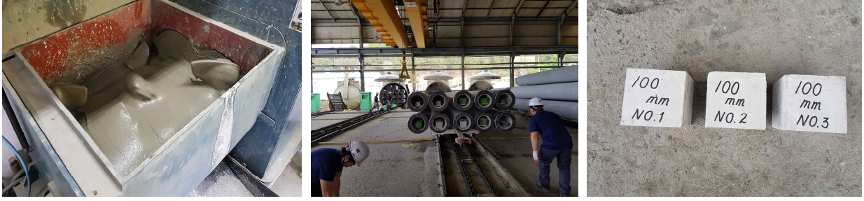
Fig. 1 AAC 배합실험후 Autoclave양생 및 공시체제작
