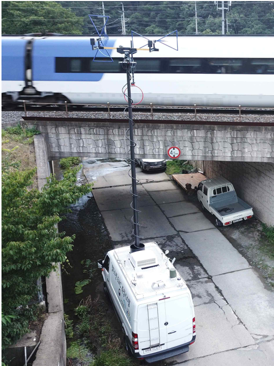
그림 2 EMC 측정차량 측정 전경
