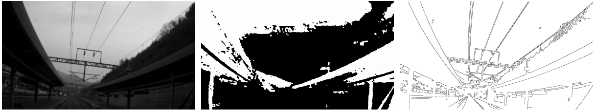
Fig. 2 HSV의 색상체계 영상 중 V 영상을 이용하여 노이즈 제거 및 이진화, 경계검출을 한 결과영상
