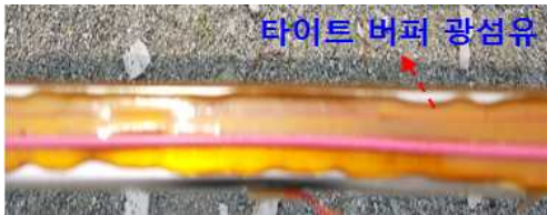
Fig. 2 에폭시 접착제를 이용한 타이트버퍼 광섬유 설치
