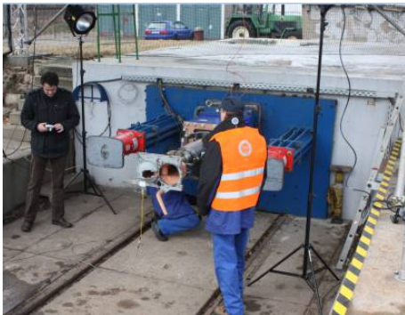
Fig. 10 동적 시험(Gas hydraulic buffer)
