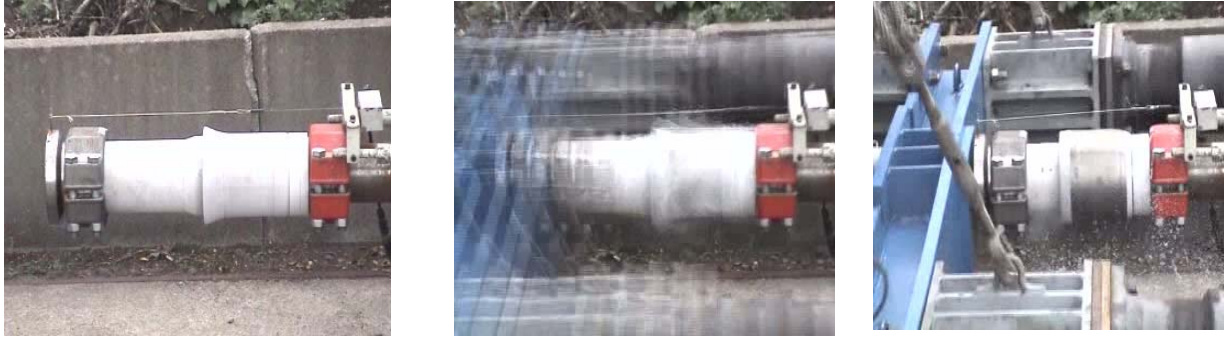
Fig. 11 동적 시험(Deformable tube)
