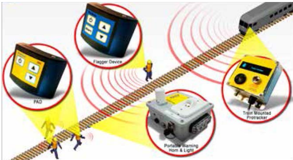
그림5 PROTRAN의 열차접근확인장치 구성도
