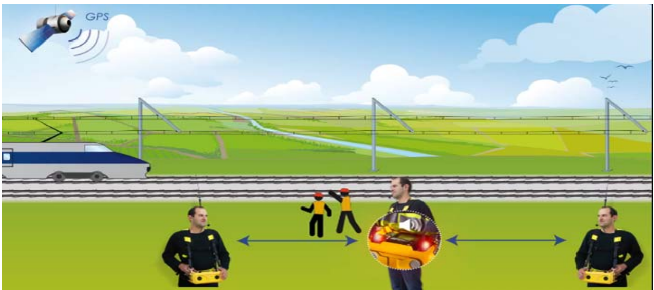
그림6 LOWS Mobile patrol의 열차접근확인장치 구성도
