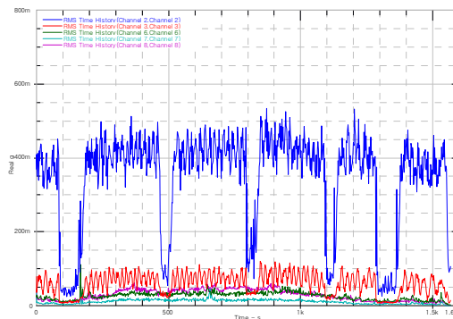
그림6. 고장 냉각팬의 진동그래프 현황
