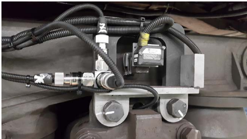
Fig. 2 차대 쪽에 설치한 가속도, 변위센서 및 배선 모습
