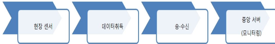
Fig. 5 신축이음매 자동측정장치 컨셉
