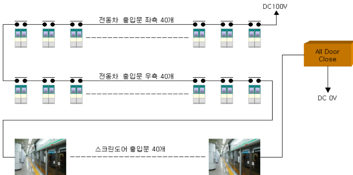
Fig. 1 전동차 출입문 Door Lamp와 PSD의 연동[3]
