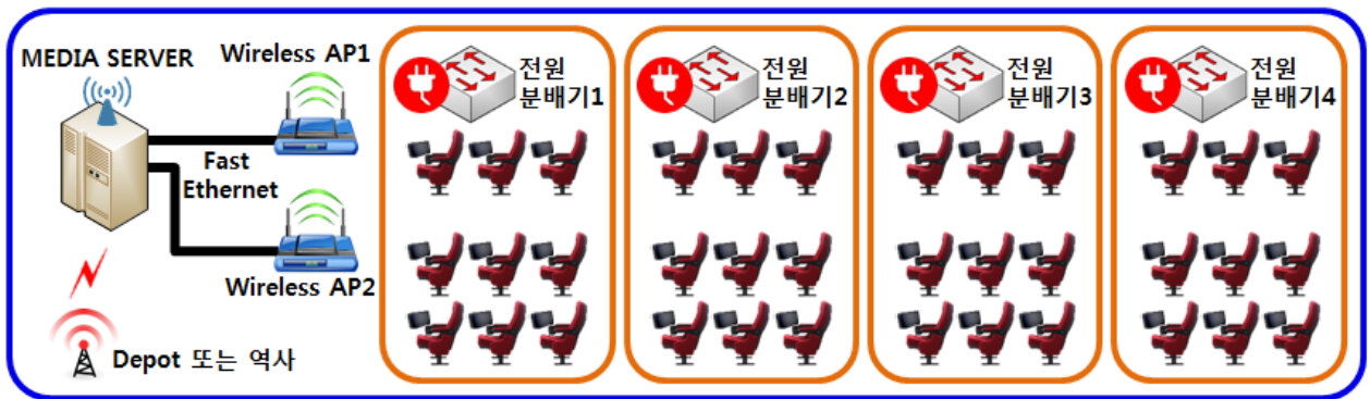
Fig. 3 무선 네트워크를 사용한 VOD 설치 개념도
